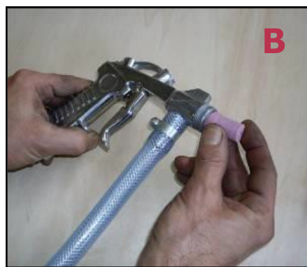
Фигура 31 – Демонтаж на дюзата на пистолета за пясъкоструене.
