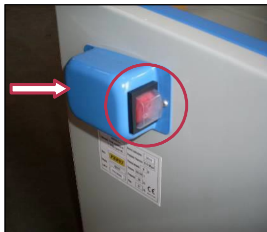
Фигура 26 – Детайл ключ и контакт за щепсел.
